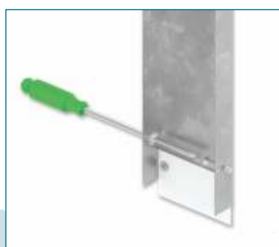
Fixação do chassi com parafuso
